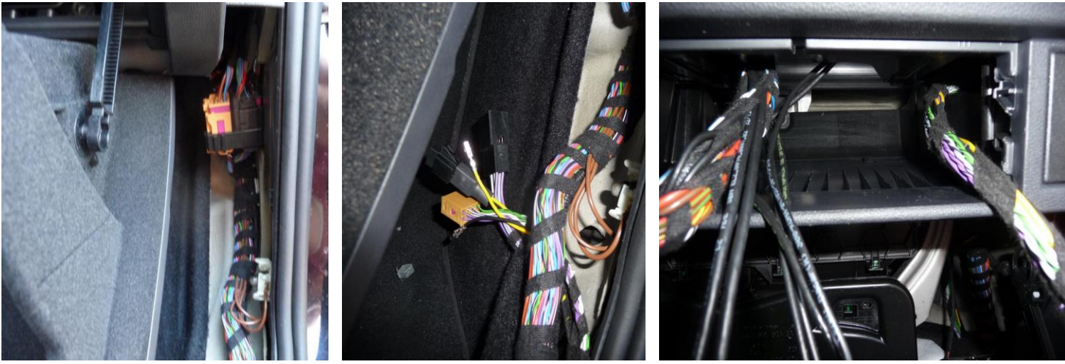
Bild 1. Den Kabelbaum hier hoch ziehen. Bild 2. Den Kabelbaum durchfädeln und nach oben ziehen. Bild 3. rechts oben im Handschuhfach sieht man eine Öffnung. Vorerst bis hier hin den Kabelbaum verlegen. Wie auf dem Bild erkennbar kommen die originalen Kabel aber alle von weiter links und von weiter oben.
